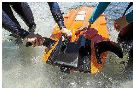
Das ist die Kielseite des Elektro-Boards. Jördis Schneider zeigt, wie die Flossen am Rumpf angebracht werden.
